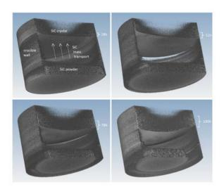
Die Collage zeigt in Form von Röntgenbilddaten das Kristallwachstum im glühend heißen Graphittiegel im zeitlichen Verlauf. © Wiley-VCH Verlag GmbH & Co. KGaA | Bild in Farbe und Druckqualität: www.iis.fraunhofer.de/pr.
